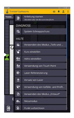
Mit einem **System-Schnappschuss** können alle relevanten Maschinendaten auf einmal gesichert werden. Einfach oben rechts auf die drei Punkte tippen und im Untermenü auf **System-Schnappschuss** tippen.
