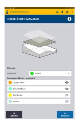
Für die Nutzung der Ansicht von mehreren Oberflächen, ist die Ausgabe mehrerer Oberflächen (zzgl. Linien und Punkte) über eine VCL Datei in Trimble Business Center nötig.
