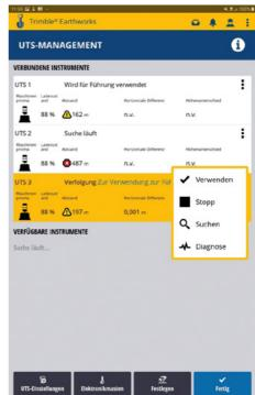
Sie können jede Totalstation zur Führung nutzen, die sich innerhalb des maximalen Abstands befindet. Tippen sie hierzu auf die **drei Punkte** im Feld der UTS und anschließend auf **Verwenden**. Die zweite und schnellere Methode ist, einfach bei der gewünschten UTS auf **Zur Verwendung zur Führung antippen zu tippen**.
