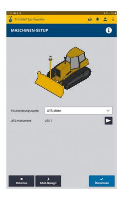
Über **Positionierungsquelle** kann man die gewünschten Sensoren für die Positionierung auswählen. Zur Auswahl steht Dual GNSS (bei Raupen mit GNSS), GNSS Centered (Fixed Mast), UTS Mitte und 2D.
