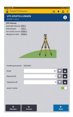
Im Menü UTS-Einstellungen haben Sie die Möglichkeit den **Kanal**, die **Netzwerk ID** und **Zielzeichen ID** zu ändern. Mit dem Schalter Autom. Suche kann die automatische Suchfunktion der UTS aktiviert oder deaktiviert werden. Standardmäßig ist die automatische Suche aktiviert. Über die untere Schaltfläche **Erweitert** ist es möglich die oben angegebenen UTS Toleranzen zu ändern.
