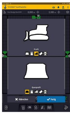
Sie haben die Auswahl zwischen 3D Ansicht, Kartenansicht, Längsprofil der Maschine, Querprofil der Maschine und der Libellenanzeige.
