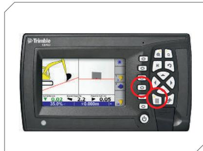
1. Zur Aufzeichnung des ZSNAP's **Menü-Taste** drücken und gedrückt halten anschließend **Softkey F4** kurz drücken. Danach **Menü-Taste** loslassen.
